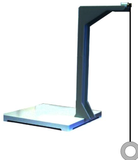
Inicialmente fixe o transferidor no pino de metal da haste de plástico e, após encaixar a haste na base de plástico, use as etiquetas adesivas para fixar a base na mesa. Amarre uma extremidade do fio à arruela e a outra extremidade ao pino da haste, conforme figura acima. Garanta que o comprimento do fio seja da ordem de um metro.
