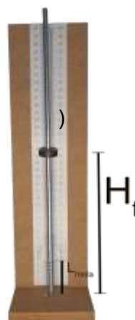
Figura 3: Representação da altura de retorno H_f (note que essa altura de retorno é mera representação)
